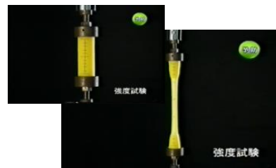
ポリエチレン管の 強度試験（例）
