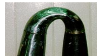
中圧導管の 強度試験（例）
