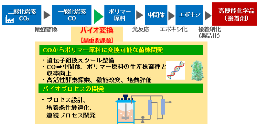
図9 バイオものづくり技術によるCO 2 を原料とした高付加価値化学品の製品化イメージ
