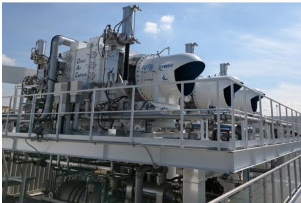
図3 大阪・関西万博会場に設置したパイロット試験機のDACユニット
