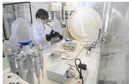
図 6 遺伝子操作等を行うための専用の嫌気チャンバー
