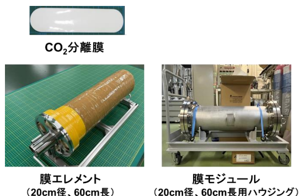
図 15 \text{CO}_2 分離膜、膜エレメント(大面積の膜、支持体および流路材等の部材を一体化したもの)および膜モジュール(膜エレメントと収納容器(ハウジング)を組み合わせたもの)
