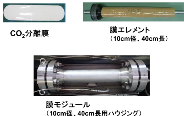
図10 CO 2 分離膜、膜エレメント(大面積の膜、支持体および流路材等の部材を一体化したもの)および膜モジュール(膜エレメントと収納容器(ハウジング)を組み合わせたもの)
