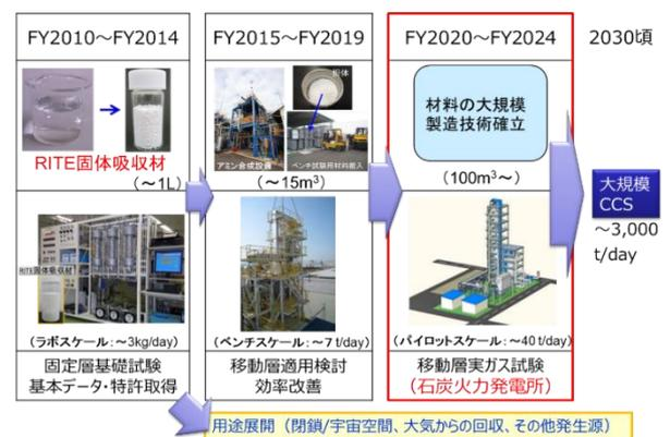
図3 固体吸収法の開発ロードマップ
