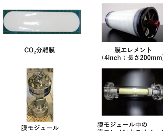
図11 CO 2 分離膜、膜エレメント（大面積の膜、支持体および流路材等の部材を一体化したもの）および膜モジュール（膜エレメントと収納容器（ハウジング）を組み合わせたもの）
