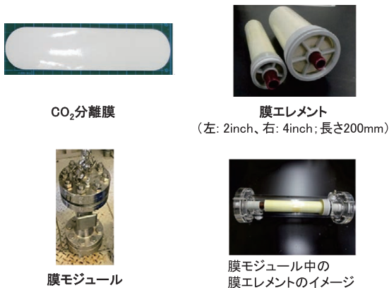
図11 CO 2 分離膜、膜エレメント（大面積の膜、支持体および流路材等の部材を一体化したもの）および膜モジュール（膜エレメントと収納容器（ハウジング）を組み合わせたもの）
