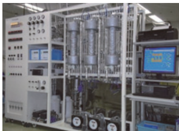
図6 小型連続回収試験装置
