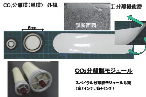
図6 CO<sub>2</sub>分離膜及びCO<sub>2</sub>分離膜モジュール
