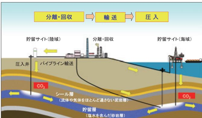
図1 CO<sub>2</sub> 地中貯留の概念図
