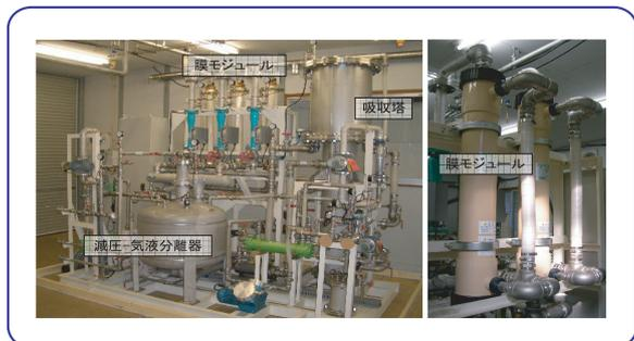
図 6 RITE/ 太陽日酸(株) 共同開発のバイオガス濃縮実証試験装置
