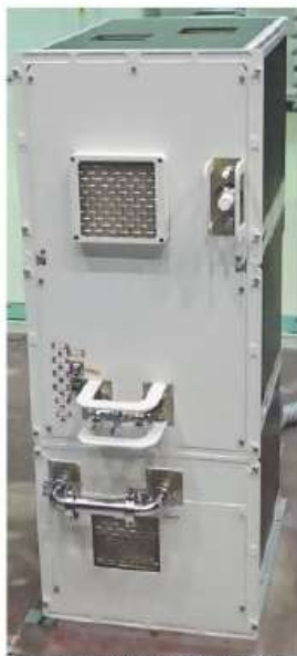
ISSでの性能試験用に開発されたCO 2 除去装置—2023年7月、茨城県つくば市(JAXA提供)
