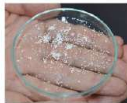
CO 2 を吸着する液体「アミン」を染み込ませた粒子状の材料
