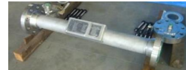
膜モジュール (膜エレメント+収納容器)
