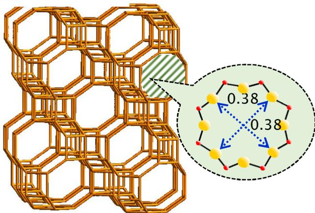
・8員環細孔 (0.38 nm, 3次元構造)
