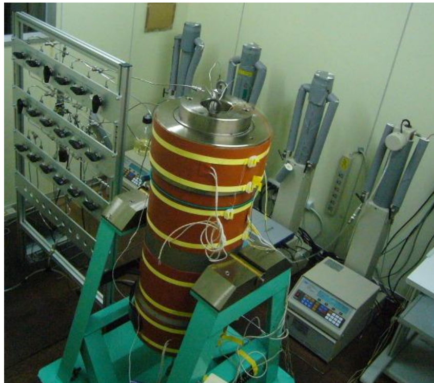
圧力容器(中央), 4台のシリンジポンプ(右上), 操作バルブ(左)で構成
