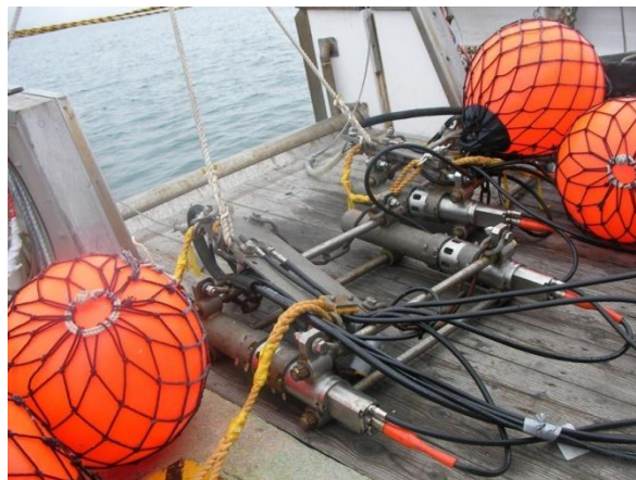
圧縮空気を用いる小型振源 (480cu.in)
