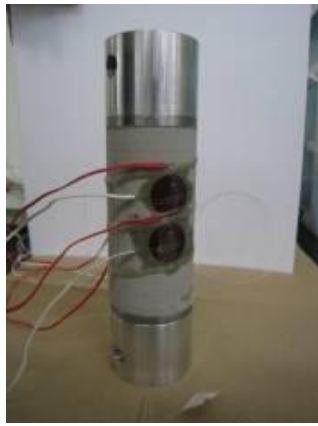
図3 光ファイバーとひずみゲージの配置図
