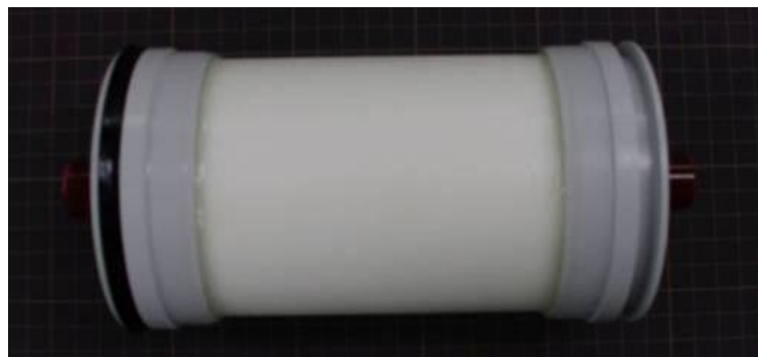
スパイラル型分離膜モジュール(試作)
