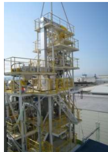
移動層ベンチスケール試験装置 (5 ton-CO 2 /day) @ 川崎重工業(株)
