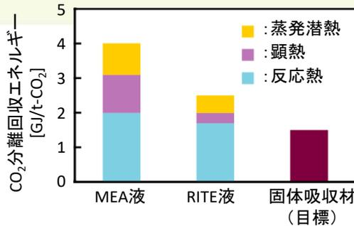
固体吸収材は、CO<sub>2</sub>吸収剤であるアミンを多孔質支持体に担持した固体であり、アミン吸収液と類似のCO<sub>2</sub>吸収特性を有しながら吸収液顕熱や蒸発潜熱の大幅低減が期待できます。RITEでは、経済産業省から委託された先進的二酸化炭素固体吸収材実用化研究開発事業においてCO<sub>2</sub>分離回収エネルギーの大幅な低減を目指して、川崎重工業株式会社 (KHI) とともに研究開発を進めています。
