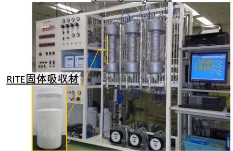
RITEは、計算化学を活用して、新規なアミン吸収剤を探索し、低温再生可能なCO<sub>2</sub>高効率回収型の固体吸収材を作製することに成功しました。ラボスケールのCO<sub>2</sub>分離回収試験装置を用いてプロセス性能評価を実施し、操作条件の最適化を行った結果、石炭火力発電所の排ガス程度 (11~12%CO<sub>2</sub>) の湿潤CO<sub>2</sub>ガスに対する世界トップレベルの分離回収性能 (回収純度>98%、回収率>93%、回収エネルギー<1.5GJ/t-CO<sub>2</sub>) を実証しました。また、本材料は有人閉鎖空間用などの再生型CO<sub>2</sub>吸着剤としての用途展開も検討しています。
