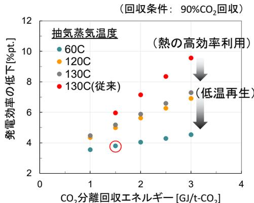
発電システムレベルでのプロセスシミュレータを構築し、CO<sub>2</sub>分離回収技術が発電効率に与える影響を評価しています。低温で再生する固体吸収材 (1.5 GJ/t-CO<sub>2</sub>) は、高性能吸収液 (2.5 GJ/t-CO<sub>2</sub>) と比較して、発電効率の低下を約2%軽減できると推算されています。
