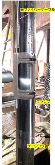
光ファイバーを利用したひずみ、温度、音響のマルチセンシング技術は、CO<sub>2</sub>挙動モニタリングにおいて、低コストの監視を実現可能にします。
