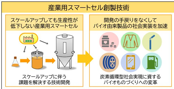
■スケールアップするとしばしば予期せぬ生産性の低下が観察されます。ラボでの小規模スケール検討と比較して、巨大発酵槽内では局所的な培養環境変化が起こり易く、この培養環境不均一性に起因した培養ストレスが生産性低下の一因と考えられます。
