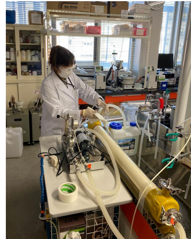
Post combustion CO 2 capture 5 m 2 中空糸膜モジュール 九州大学 谷口グループ
