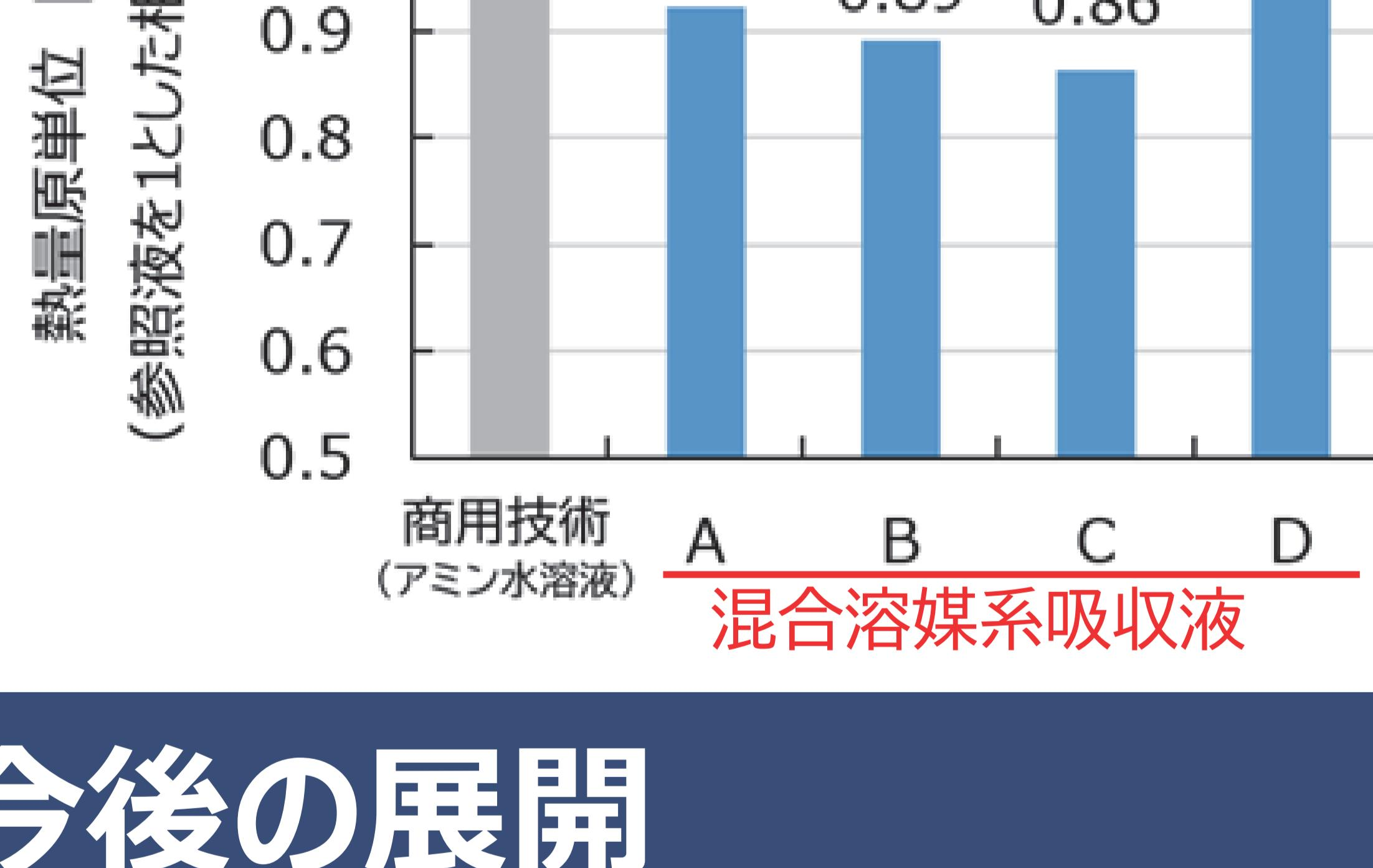
混合溶媒系吸収液の優れた性能が実ガスベンチ試験においても確認された。この結果を踏まえ、2025年度、パイロットプラント(CAT-30)試験を実施。
