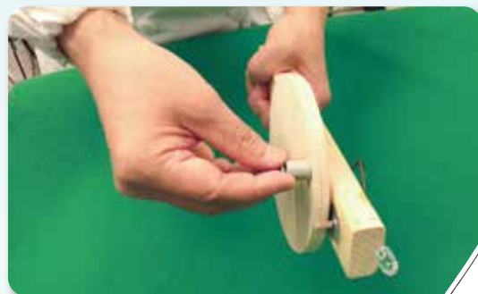
電池なしであかりをつけることができる 「手回し発電機」
