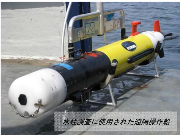
水柱調査に使用された遠隔操作船
