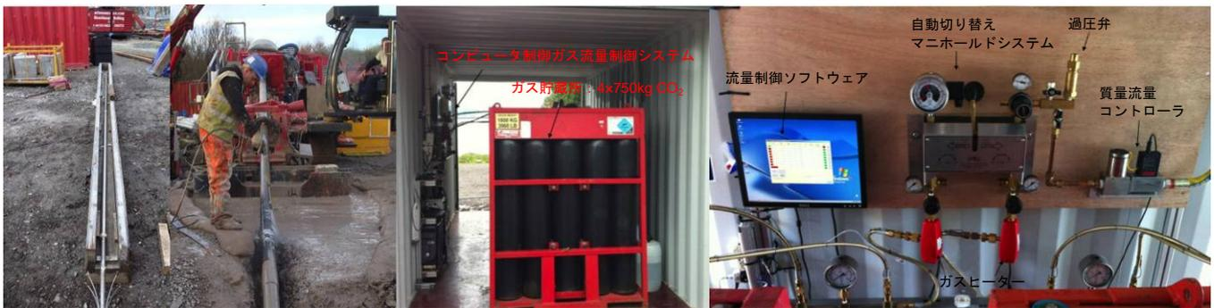
図3. 左からーガス拡散器、掘削リグ、ガス放出コンテナおよび制御システム
