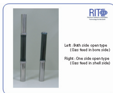
Fig.1 Carbon membrane modules incorporating cesium atom
