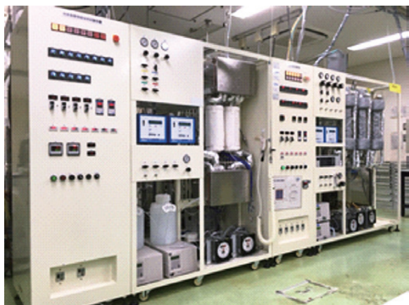
図7 ラボスケール固定層試験装置
