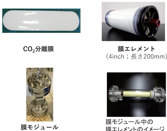
図12 CO 2 分離膜、膜エレメント（大面積の膜、支持体および流路材等の部材を一体化したもの）および膜モジュール（膜エレメントと収納容器（ハウジング）を組み合わせたもの）
