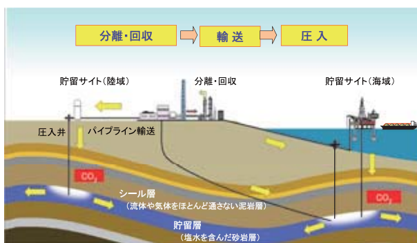
図1 CO 2 地中貯留の概念図
