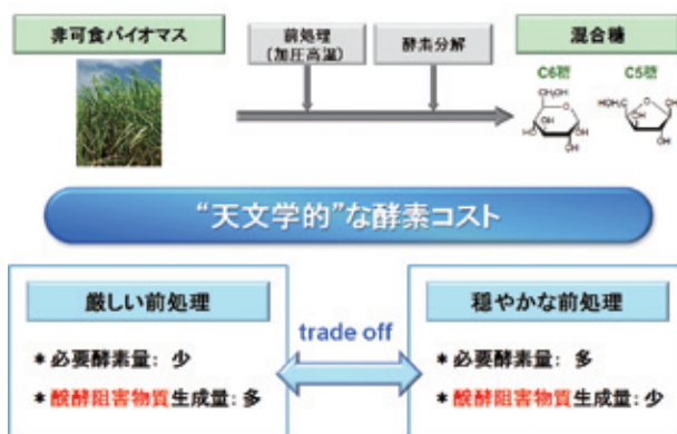
図4 “セルロースエタノール生産”実現への障害
