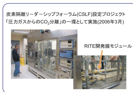
図 8 米国 DOE/NETL における実験の様子
