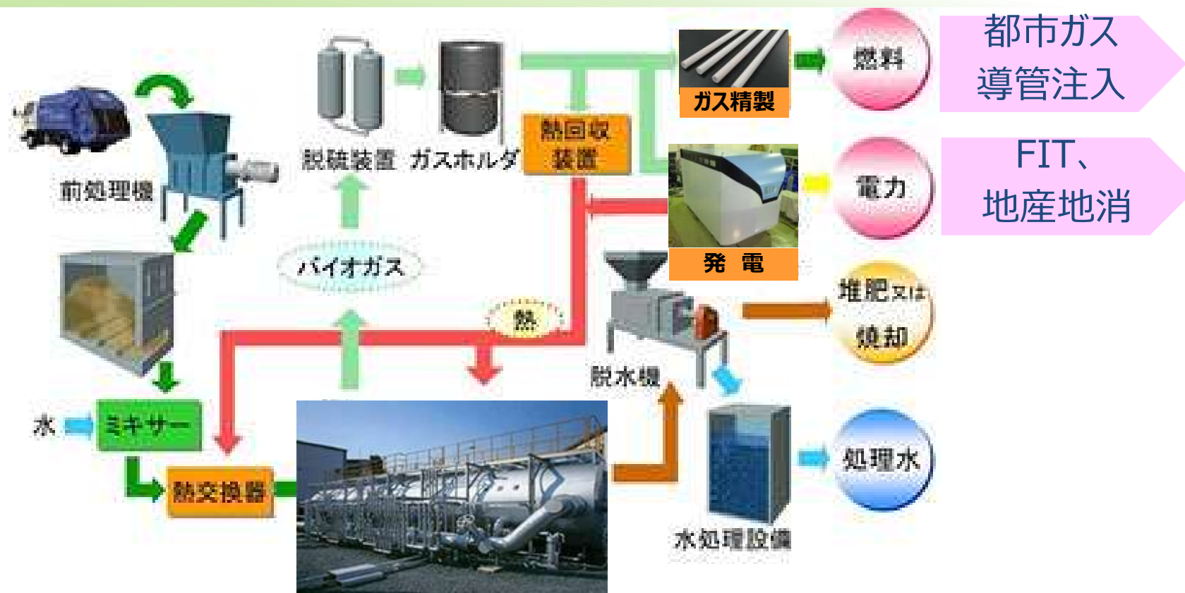
乾式メタン発酵システムフロー
