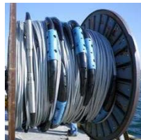
ジオフォン(3成分)(固有周波数:15Hz) ハイドロフォン
