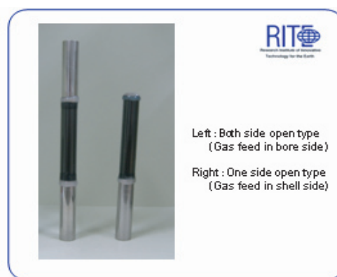
Fig.1 Carbon membrane modules incorporating cesium atom
