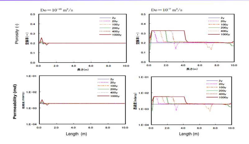
Reaction conditions: 50°C、100kg/cm<sup>2</sup>、 pH: 3、 CO3<sup>2-</sup> diffusion coefficient (inside plug):  $1 \times 10^{-10}$ 、  $1 \times 10^{-7}$  m<sup>2</sup>/s
