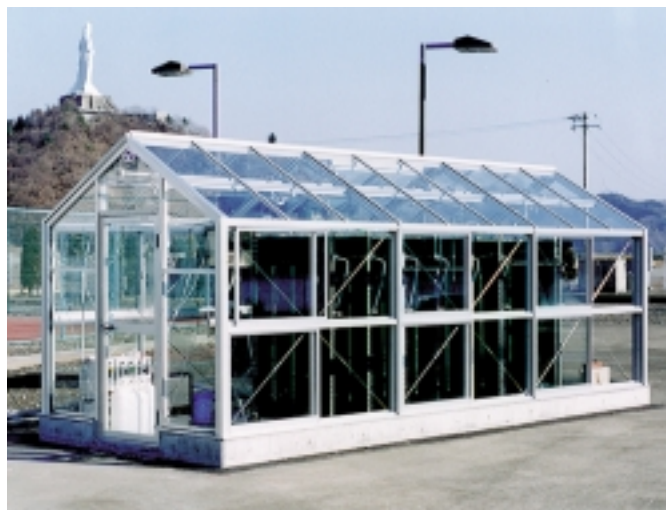
パネル型リアクタによるCO 2 固定実験（MBI分室・釜石市）
